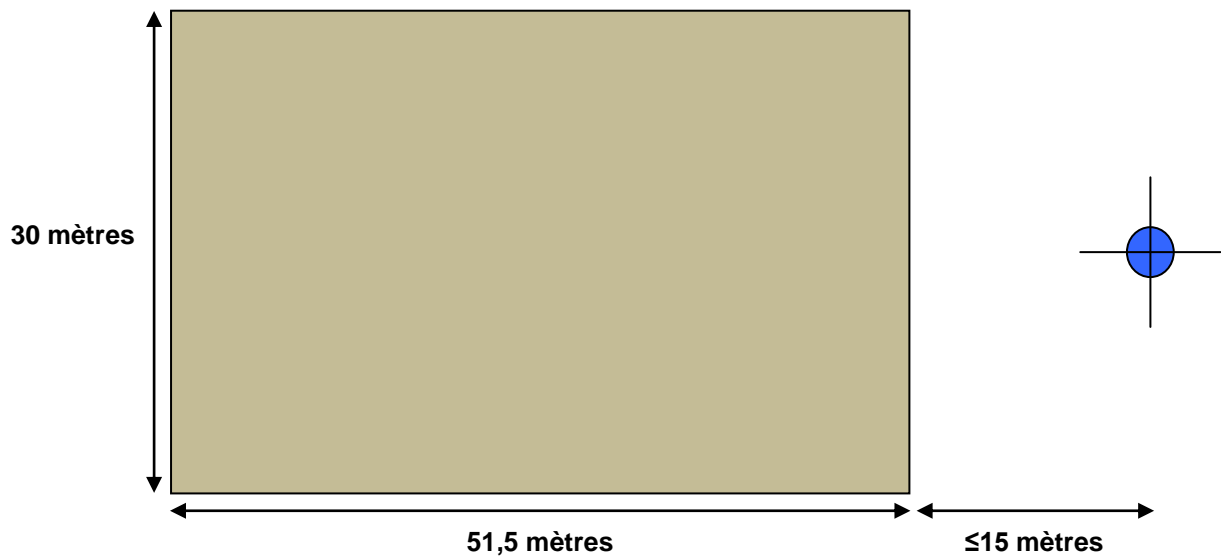
Figure 14 : Dimensions d'une plate-forme-type
